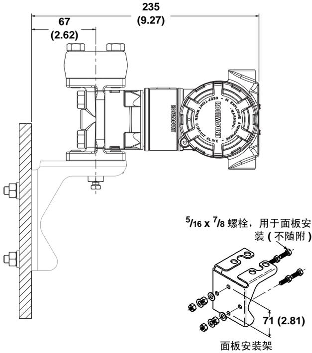
2 英寸管道安装架 (选件 B1/B7/BA)
