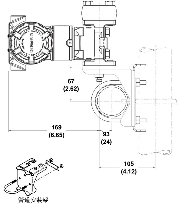
2 英寸管道安装架 (选件 B3/B9/BC)
